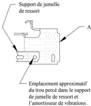
**REMARQUE :** Sur les modèles Flareside, l'amortisseur de vibrations ne peut pas être réinstallé avec l'attelage, de sorte qu'il doit être retiré en permanence.
