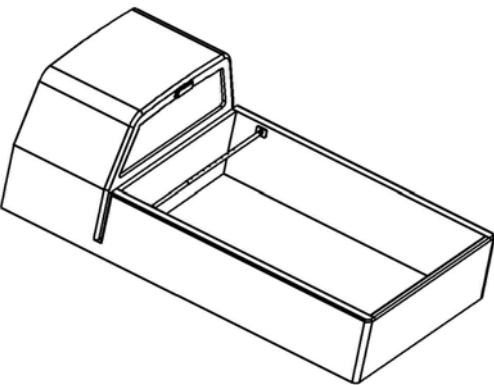
Ajuster la largeur de la barre de chargement à celle de l'intérieur de la zone de chargement.
