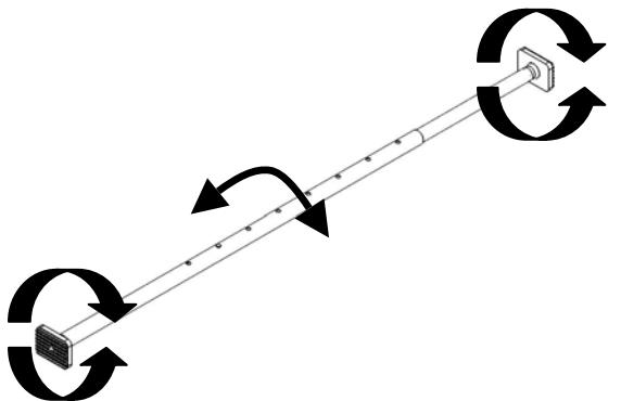
Tourner les tampons d'extrémité jusqu'à ce qu'ils touchent aux parois de la zone de chargement. Ensuite, tourner la barre pour la serrer. Serrer cette dernière jusqu'à ce que la cargaison soit bien arrimée. **Faire attention de ne pas trop serrer la barre de chargement, puisque cela risque d'endommager la zone de chargement.**
