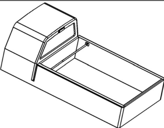
Ajuste la anchura de la barra de carga a la anchura interior del área de carga.
