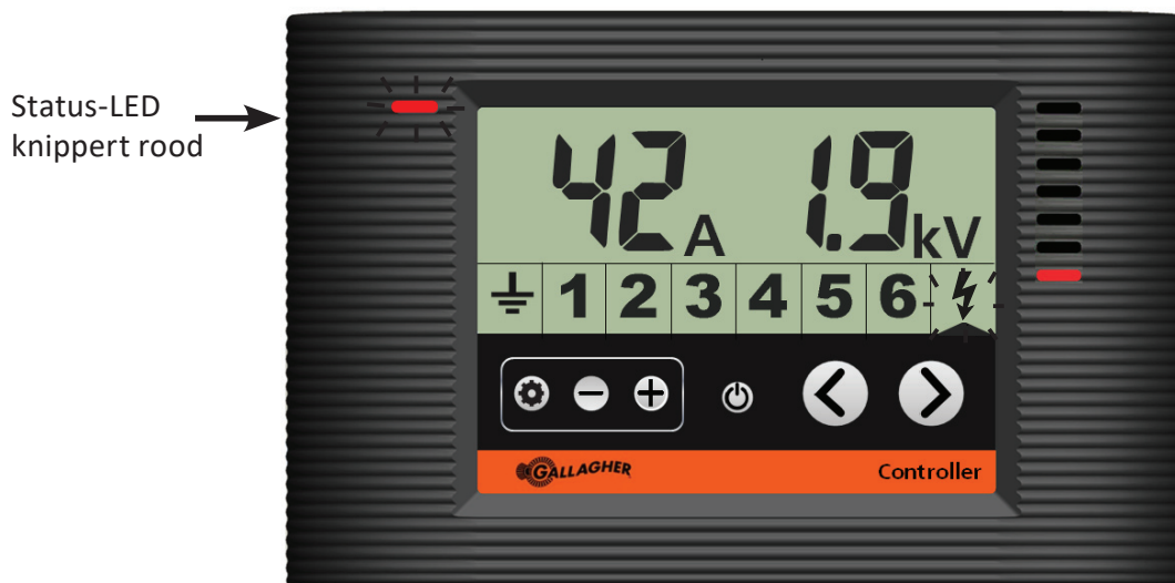
Bedieningspaneel toont het schrikdraadapparaat in stroomsterktealarm
