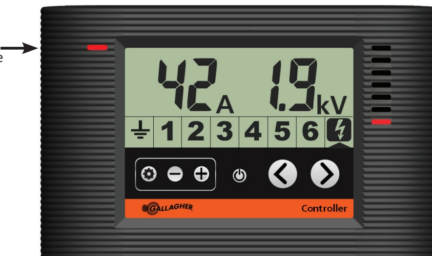
Contrôleur montrant l'électrificateur en état d'alarme
