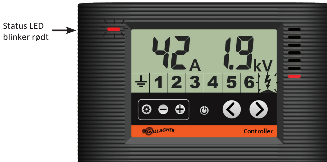
Styreenheden viser energizeren i strømstyrke alarm
