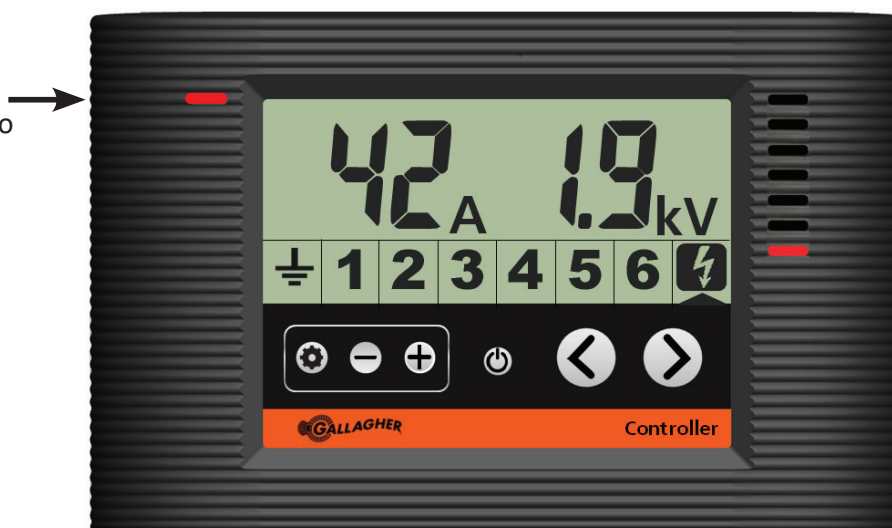
Elettrificatore in allarme voltaggio d'uscita
