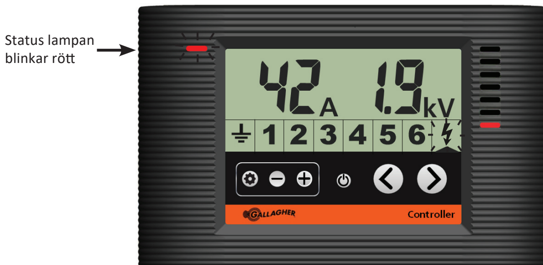
Kontrollen visar aggregat i ström larm
